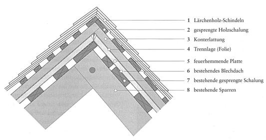
struktionshöhen an Ort, First und Trauf im Falle der Eindeckung mit einer Metallhaut in etwa gleich stark, wie bei einer solchen mit Schindeln.
