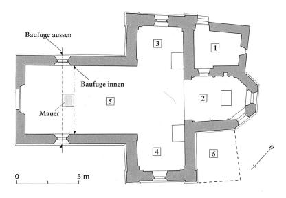
baut. Die Steinplatten des Mittelganges wurden entfernt und die darunter liegende Schuttschicht bis zu 30 cm abgetragen. In diesem Bereich konnte eine gemörtelte Bruchsteinmauer gefasst werden (Abb. 55). Die Ost-West orientierte Mauer weist eine Breite von 90 cm auf. Ihre Aussenflucht liegt auf einer Linie mit den oben beschriebenen Baufugen im aufgehenden Mauerwerk. Damit konnten die Resultate der Bauuntersuchung durch den Mauerbefund im Boden bestätigt werden.
