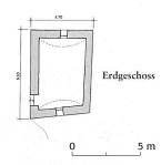
Abb. 184: Silvaplana, Surlej, Haus Lutz. Rekonstruktion des im Gebäude enthaltenen Kernbaus. Mst. 1:300.
