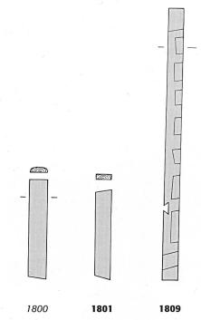
Abb. 72: Silvaplana, Brücke Surlej. Die dendrochronologischen Daten der einzelnen Hölzer. Fett: gesichertes Fälldatum; kursiv: unsicheres Fälldatum; normal: geschätztes Fälldatum. Mst. 1:50.
