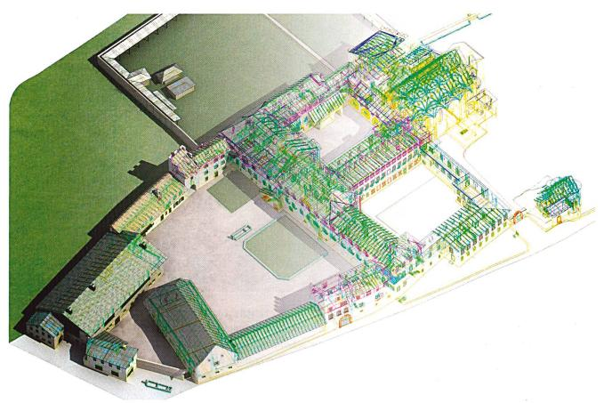
Abb. 34: Müstair, Kloster St. Johann. Computer-3D-Grundmodell der bestehenden Klosteranlage: Von rechts nach links entwickelt sich aus dem geometrischen Skelett das mit Materialstruktuen "bekleidete" Modell. Das Skelett zeigt von ferne die geometrische Hintergrundarbeit mit sämtlichen inneren und äusseren Konstruktionslinien des Modells. Es bildet die Grundlage für jede künftige 3D-Darstellung der zahlreichen Bauetappen seit karolingischer Zeit.
