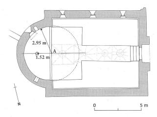
Abb. 121: Evangelische Filialkirche Giarsun. Grundriss mit eingezeichnetem Kreis (Radius 2,95 m) und optimaler Sprecherposition (Stern). Mst. 1:200.
