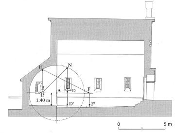
Abb. 124: Evangelische Filialkirche Giarsun. Längsschnitt Mst. 1:200. Konstruktion der geometrischen Interpretation der zwei Bodenpunkte D und F mit A: Kreiszentrum, B: Quellpunkt, H und N: Schnittpunkte der Schallstrahlen am Kreis.
