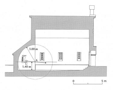
Abb. 122: Evangelische Filialkirche Giarsun. Längsschnitt mit eingezeichnetem Kreis (Radius 3 m) und optimaler Sprecherposition (Stern). Mst. 1:200.
