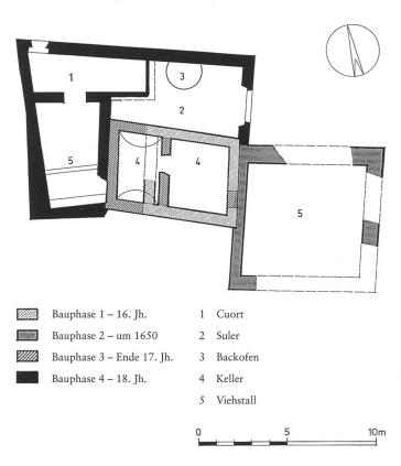
des Kernbaus wurde ein Stallraum ca. 6 m / 3m angebaut, der durch eine kleine «Cuort» mit einer Türe auf der Nordseite erschlossen wurde.
