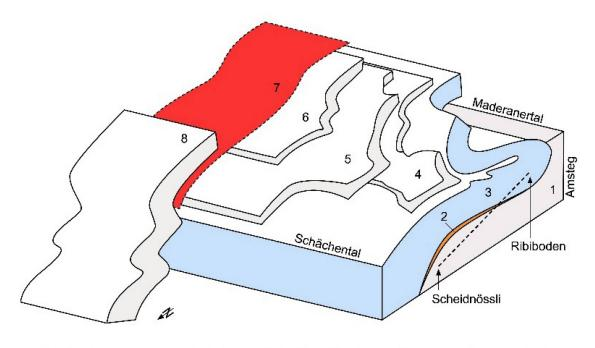
Abb. 2: Tektonisches und geologisches Profil der Windgällen-Region. Die gestrichelte Linie hebt das Auskeilen der Trias-Sedimente beim Ribiboden und weiter südlich hervor. (1) Kristallines Grundgebirge des Aar-Massivs. (2) Röti- und Mels-Fm. (3) Autochthone Sedimente des Aar-Massivs. (4) Hoch-Fulen-Decke. (5) Griessstock-Decke. (6) Kammlistock-Decke. (7) Glarner Hauptüberschiebung. (8) Axen-Decke. Koloriert nach strati (2018). Verändert nach Brückner und Zbinden (1987); Röthlisberger (1990).
