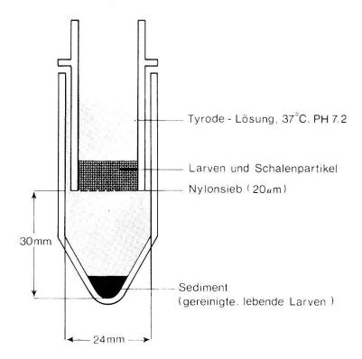
Abb. 2. Modifizierter Baermann-Apparat zur Reinigung der Larven.
