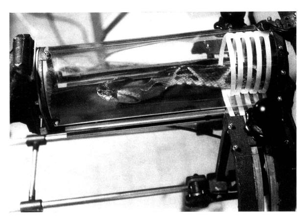
Fig. 4. Le serpent en pénétrant dans le tunnel passe à travers les deux fixations, la première est actionnée et le maintient.
