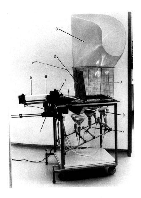
Fig. 3. Appareil de contention: A: Partie supérieure de la cage; B: cornet en celluloide; C: couvercle; D: partie inférieure de la cage; E: batterie de lampes; F: première fixation; G: tunnel en plexiglass; H seconde fixation; I: charriot de la seconde fixation.
