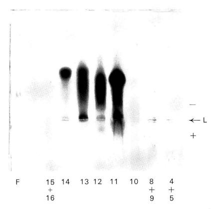
Fig. 10. Elektrophoretische Trennung der Biogel  $P_{30}$ -Fraktionen  $4\pm5$ ,  $8\pm9$ , 10—14 und  $15\pm16$ . Vgl. Fig. 9. 5%ige Lösung, je 2 ml; sonst gleiche Bedingungen wie Trennung Fig. 8.
