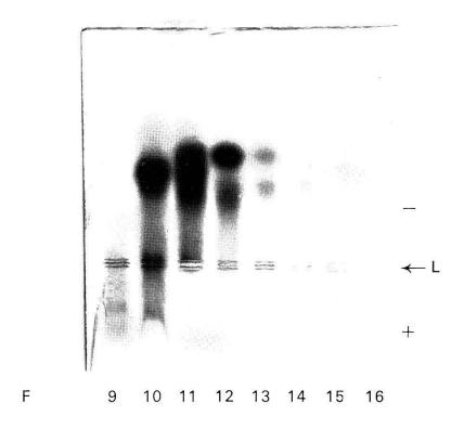
Fig. 8. Elektrophoretische Trennung der Biogel P<sub>2</sub>-Fraktionen 9—16. Vgl. Fig. 7. 5%ige Lösung, je 2 ml; Gelplättchen 7,5  $\times$  7,5 cm aus 1% Agar-Agarose (5:1) in 0,05 m Na-Veronal-Puffer, Schichtdicke ca. 1,5 mm; Trenntemperatur 12°, Spannung 155 V, Stromstärke 60—65 mA, Dauer 25′; Anfärbung mit Amidoschwarz; F = Fraktionennummer aus Gelfiltration; L = Auftragelinie.
