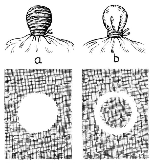
Abb. 9. Knopfförmige Abbindung (Plangi). a = Vollständige Abbindung des Stoffknöpfchens; ergibt nach der Färbung eine helle, kreisförmige Fläche. b = Abbindung des Stoffknöpfchens an der Basis; ergibt nach der Färbung einen Kreisring.
