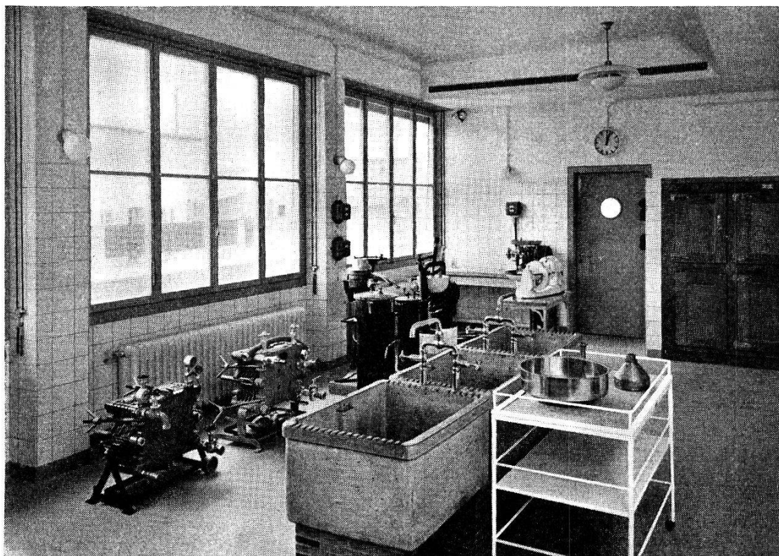
Fig. 6. Salle de fabrication avec les appareils pour le broyage, la centrifugation et la filtration du matériel virulent.
