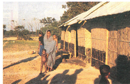
Toutes les maisons sont construites selon l'usage du Bangladesh: entrelacement de bambous fixés sur des montants de bambou.
