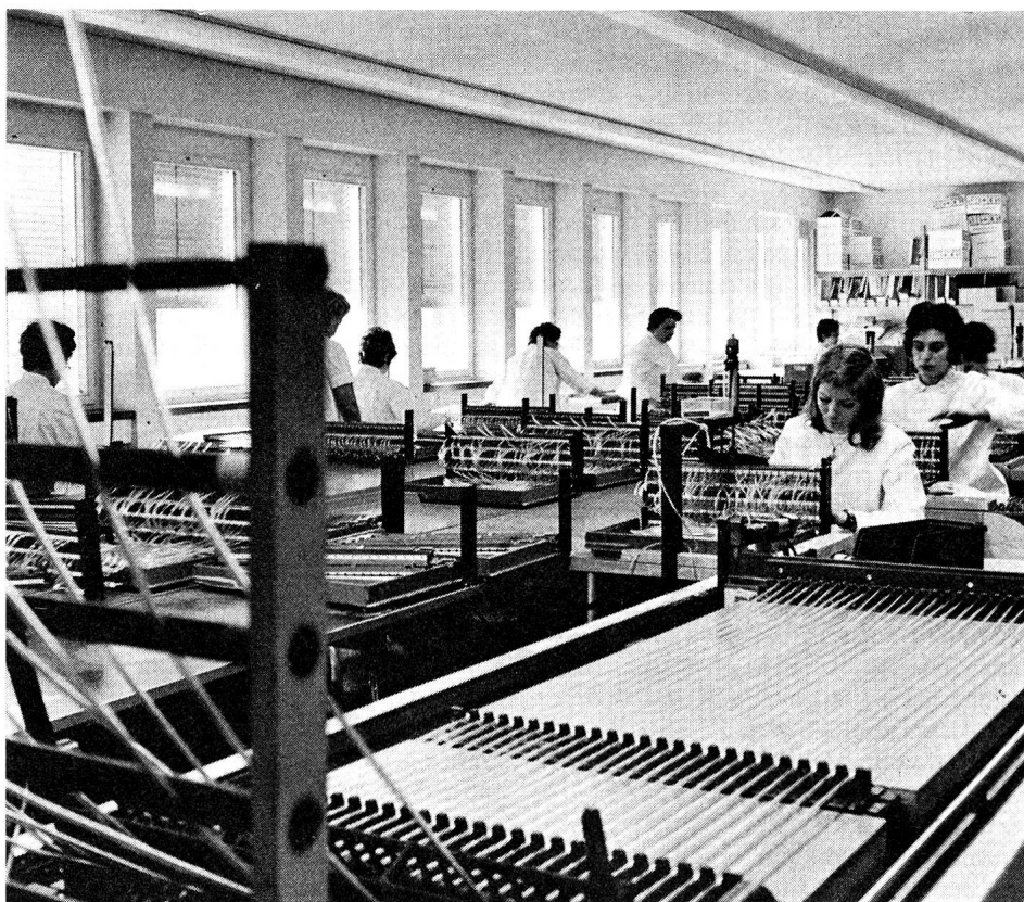
Il reparto del Laboratorio centrale dove si fabbricano i «necessari» per i prelievi, le trasfusioni e le infusioni. Foto W. Studer
