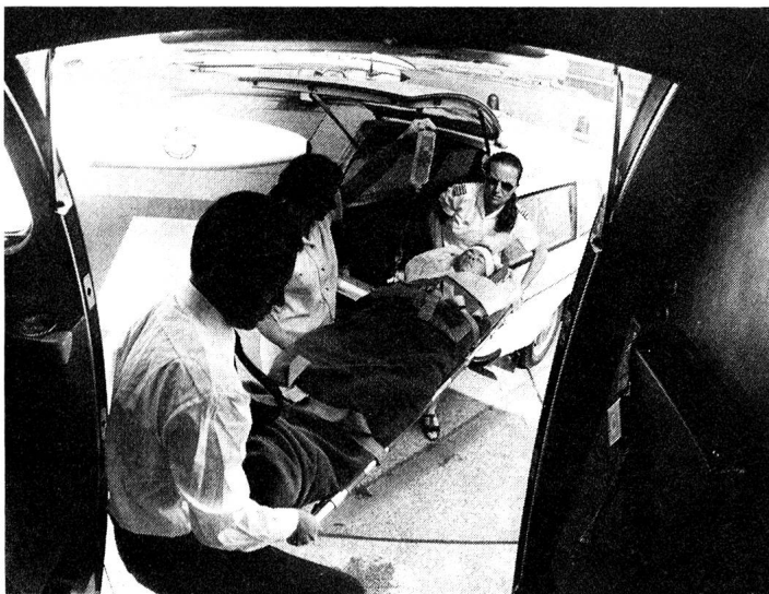
Chargement d'un patient à bord du Lear Jet: la GASS dispose de brancards spéciaux. L'un d'eux a un long coussin rempli de granules. Lorsque le patient y est installé, l'air est retiré du coussin qui se moule exactement au corps et le maintient dans une position confortable.
