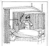
Rails sans tirage entre les lits Droits, cintrés, montés à suspension libre ou au plafond; également possible avec système à aiguillage.
