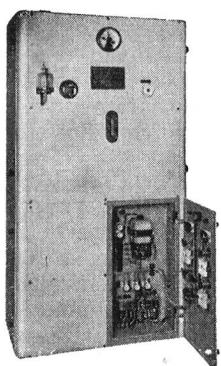
Superdistillateurs à thermocompression pour l'eau distillée
