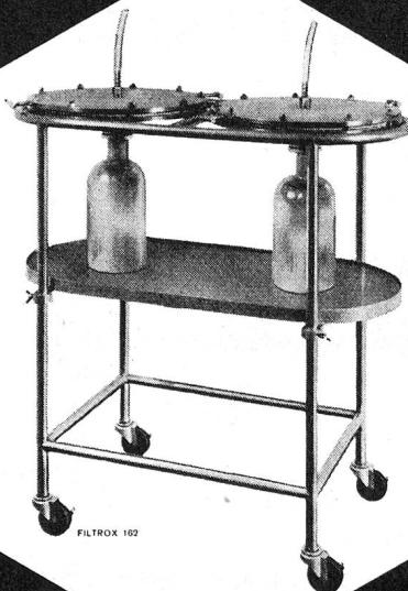
2 FILTROX—Einschichtenfilter Modell 400 mit Filter—Boy; rostfreier, säurebeständiger Stahl; Filterfläche 2 x 0,12 m<sup>2</sup>; Trubraum 2 x 1,2 l; Leistung 120—240 l/h; für die Filtration von Fibrinogen, Globulin, etc.
