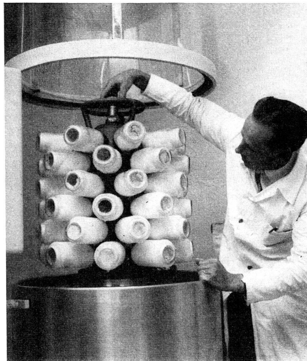
Un des quatre appareils de séchage « Manifolds » contenant chacun 48 bouteilles. (Photo A. T. P.)
