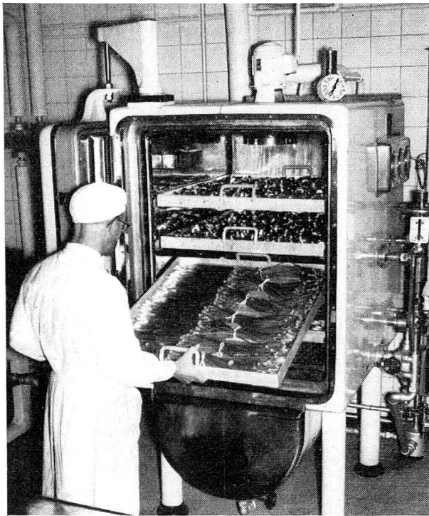
Stérilisation des flacons dans un des deux autoclaves automatiques. (A. T. P.)
