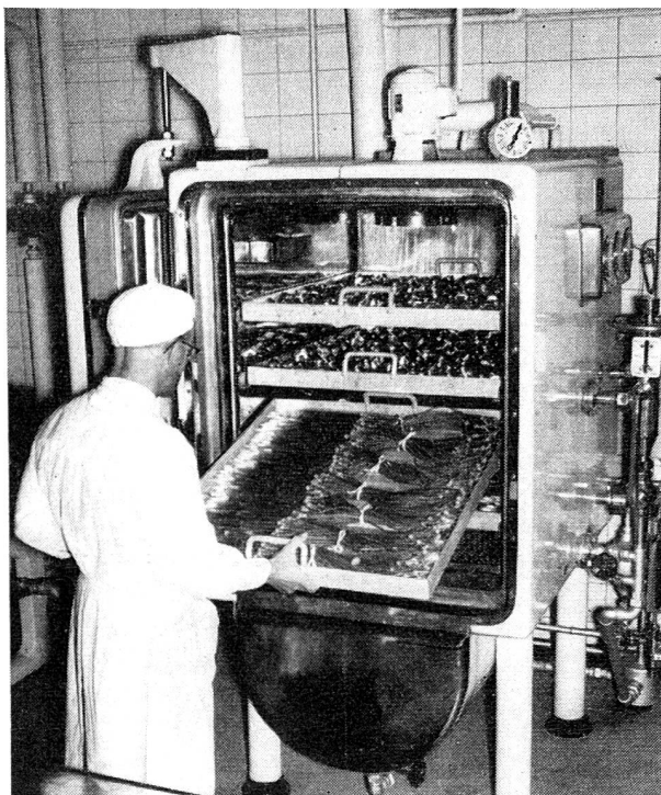
Sterilisation des flacons dans un des deux autoclaves automatiques. (A. T. P.)
