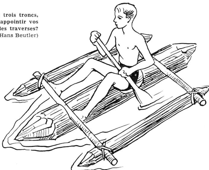
Une embarcation facile à construire soi-même pendant un camp au bord d'un lac et qui peut être utilisée pour la surveillance des baigneurs ou le sauvetage. Ne pas utiliser de clous pour lier les poutres aux traverses, mais faire de solides ligatures avec des cordes.
