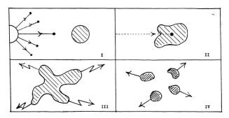
Fig. 10. — Représentation schématique de la désagrégation d'un atome d'uranium: I. Un corpuscule atomique arrive dans un atome d'uranium; II. Il pénètre dans le noyau et provoque une forte instabilité; III. Le noyau de scinde en plusieurs fragments; IV. Ceux-ci sont projetés, nous ne nous trouvons plus en présence d'uranium, mais de nouveaux éléments, différents.
