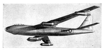
Un bombardier moderne B47 capable d'emporter 9 t de bombes. Equipage de trois hommes, vitesse de 960 km/h, rayon d'action de 6000 km, peut être ravitaillé en vol.
