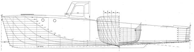
Canot à moteur de la section de Morges dessiné par M. Henri Copponex (plan de forme; au centre du dessin, couples de l'avant et de l'arrière). Vitesse: environ 40 km/h. (Plans aimablement communiqués par M. H. Copponex, à Genève.)
