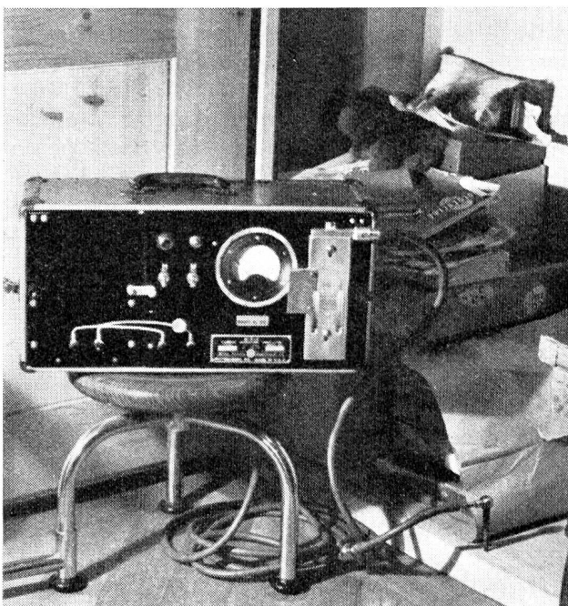
Détection d'oxyde de carbone à l'intérieur d'un soubassement d'armoire au moyen d'un appareil de détection et de mesure muni d'une ventouse.
