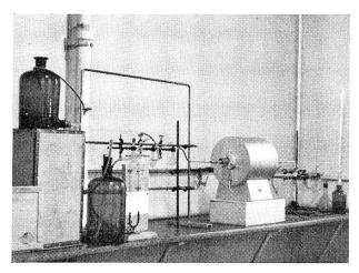
Appareil en usage au Laboratoire cantonal de Genève pour l'analyse des gaz toxiques, en particulier de l'oxyde de carbone.
