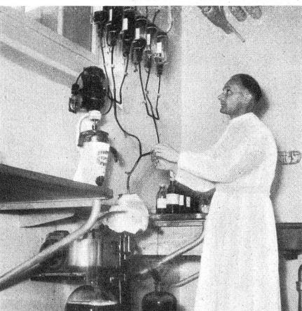
Première phase de la préparation du plasma: le sang frais est introduit dans un centrifugeur rotatif, dont le rotor tourne à une vitesse de 20 000 à 30 000 tours à la minute. Par le mouvement de rotation, les parties lourdes du sang, soit les globules rouges et blancs, sont projetées contre les parois du rotor, en laissant au milieu le plasma proprement dit. Plasma et globules sont recueillis séparément dans des bouteilles stérilisées.
