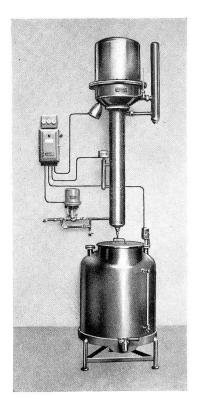
Appareil à distiller l'eau UNITYP KBC pour chauffage élèctrique, réservoir en cuivre ou en grès
