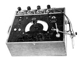
Gammes: 0-14 pH, 0-1000 mV Précision: 0,2 pH, 2 mV Employé pour des mesures du pH et du potentiel Redox ainsi que pour des titrations potentiométriques.
