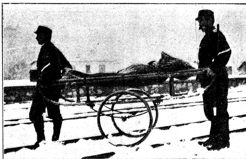
Brancard monté sur roues de bicyclette et muni de ressorts placés sous les skis
