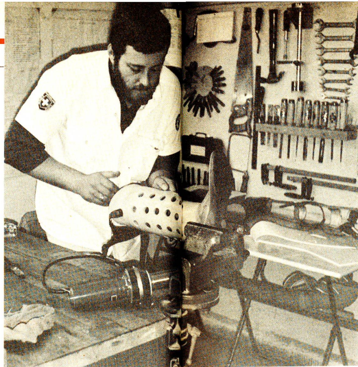
Die orthopädischen Hilfsmittel sind mit Abfallprodukten hergestellt worden (z.B. mit alten Rohren). Die Herstellungskosten können dadurch sehr niedrig gehalten werden.
