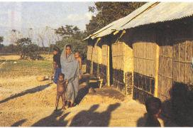
Alle Häuser sind gemäss der in Bangladesh üblichen Bauweise hauptsächlich aus einem Bambusgeflecht, das an Bambuspfosten befestigt wird, errichtet worden.
