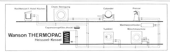
Schnellmann Ing. AG, 8057 Zürich Abt. Wärmetechnik, Telefon 051 26 67 51 Schaffhauserstrasse 57 / Schaffhauserplatz Eine moderne Wäscherei, selbst Grossküchen werden heute mit Heissöl betrieben. Der THERMOPAC ist nicht der Überwachungspflicht des SVDB unterstellt.
