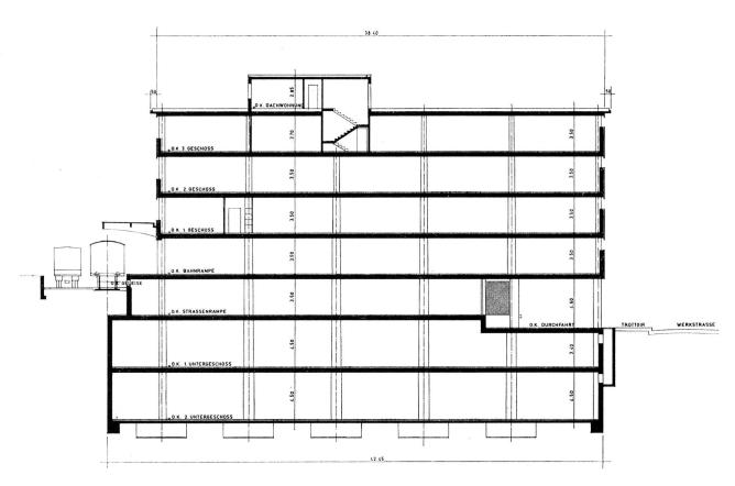
Querschnitt durch das Lagerhaus vom Bahngeleise zur Werkstrasse
