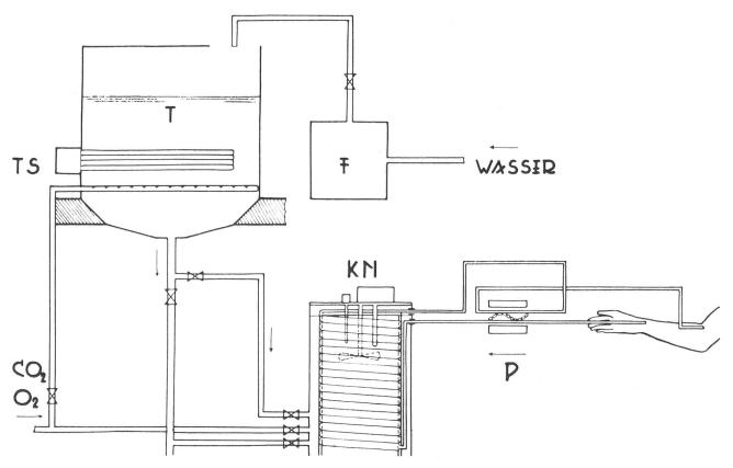
Abb. 1. Schematische Darstellung der künstlichen Niere von Alwall.
