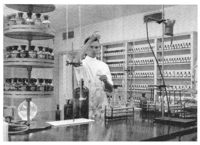
Im Betriebslaboratorium wird parallel zum Trocknungsprozess auf einer kleinen Probe des flüssigen Plasmas die Kontrolluntersuchung auf Fettgehalt und Haemoglobin ausgeführt. Der Feuchtigkeitsgehalt des fertigen Trockenplasmas wird laufend nach der Karl-Fischer-Methode überprüft.
