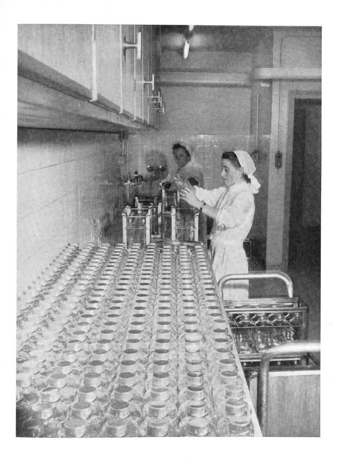
Für die Herstellung der notwendigen Abheberungs-, Entnahme und Transfusionsbestecke, die Herstellung von Anticoagulans-Lösungen, das Reinigen der Flaschen und Geräte sind modern eingerichtete Räume vorhanden. Unser Bild zeigt den Raum für die Herstellung und das Abfüllen von Anticoagulans-Lösungen. Photo ATP-Bilderdienst, Zürich.
