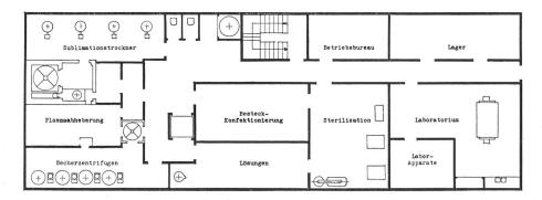
1. Stock Grundriss der Plasmaanlage Zweilütschinen
