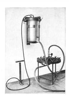
Einschichtenfilter mit Druckgefäss für Kleinfiltrationen
