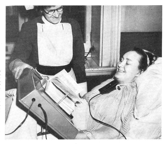
Für  $Gel\"{a}hmte$ stellt das Britische Rote Kreuz elektrische«Seitenwender» zurVerfügung, einGeschenkdesAmerikanischenRoten Kreuzes. Mittels Kinndrucks auf einen Tasterwerden die Seiten automatisch gewen-det, so dass sich auch ein total Gelähmter lange Liegezeit unabhängig mitLesen verkürzen
