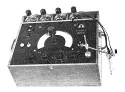
Messbereich: 0-14 pH, 0-1000 mV. Genauigkeit: 0,2 pH, 2 mV. Verwendbar für pH- und Redoxpotentialmessungen sowie für potentiometrische Titrationen.
