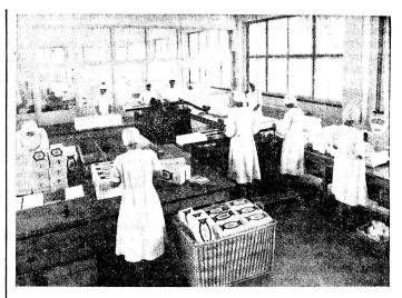
Die Wattebänder werden von der Packmaschine in Ziek-Zack-Lagen gefaltet und in die hygienischen Zick-Zack-Packungen gepresst. Das Zukleben der Packungen geschieht von Hand.
