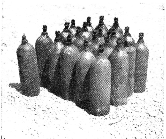
Die Standard-Eisenflaschen zum Transport von Quecksilber.
