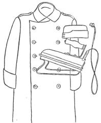
Fer à repasser. Pour éviter que le fer à repasser ne s'encrasse, le mouvoir contiuellement, surtout si l'on utilise un linge humide. Après usage, nettoyer le fer à la pierre ponce humide. Le sécher soigneusement.
