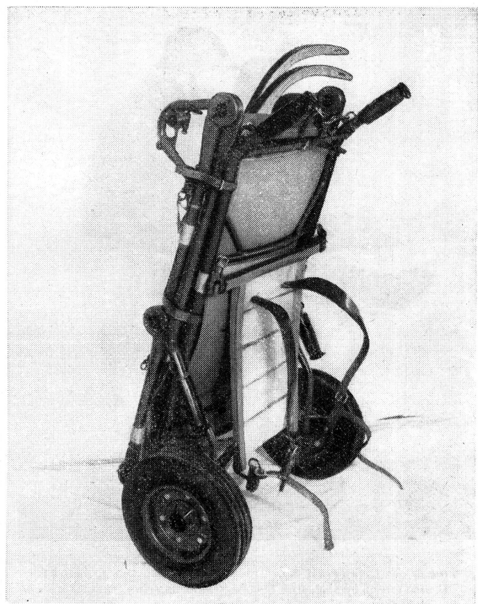
Brancard sur roues, modèle 1941, combiné avec le brancard de Weber comme civière roulante.
