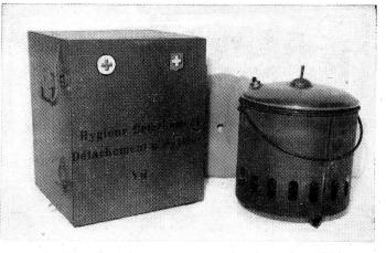
Sortiment Material für Hygien detachement. K 375 n. Nr. Kiste VII Grösse: 43 \ 39.5 \times 53 cm Gewicht: 15,5 kg Inhalt: Desinfektionsapparat Flügge für Formalindesinfektion
