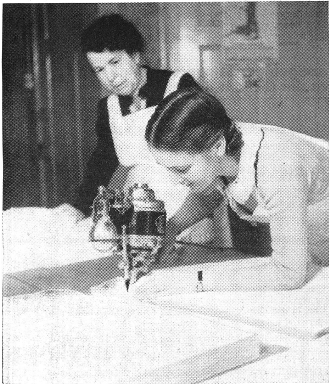
Ein Schneideratelier hat dem Zweigverein vom Roten Kreuz, Olten, eine Zugschneidemaschine zur Verfügung gestellt. Dank dieser Maschine und der grossen Schicklichkeit der Frauen vom Zweigverein ist es möglich, bis zu 105 Wäschestücke auf einmal zu schneiden.
