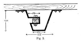
l'échancrure duquel se loge l'extrémité des traverses. En faisant pivoler celles-ci sur l'un des côtés, le démontage du brancard se fait avec grande facilité. Il ne reste plus qu'à rapprocher les deux montants et à les enrouler dans la toile pour le réduire à sa forme la moins encombrante.
