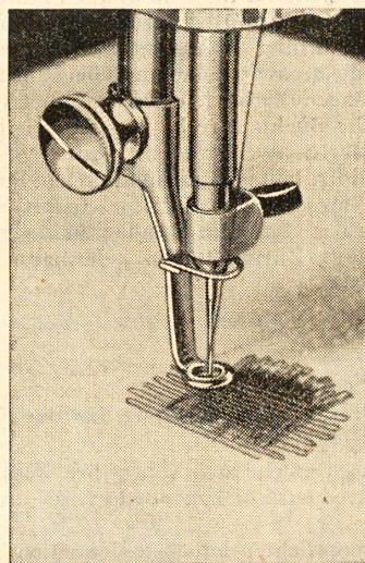
Im Nu ist das patentierte Hüpfen-Verwebfüsschen aufmontiert und schon ist die Bernina-Nähmaschine eine eigentliche Verwebemaschine. Das Wiefel wird durch diesen Hüpfen-Verwebmechanismus kinderleicht, und ohne Einspannen in den Stickring können Sie auch aussen am Rande verweben.
