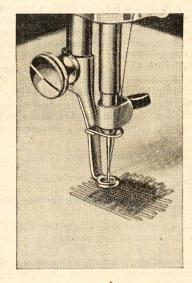
Im Nu ist das patentierte Hüpfer - Verwebfüsschen aufmontiert und schon ist die Bernina-Nähmaschine eine eigentliche Verwebmaschine. Das Wiefeln wird durch diesen Hüpfer-Verwebmechanismus kinderleicht, und ohne Einspannen in den Stickring können Sie auch aussen am Rande verweben.
