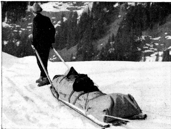
Rettungsschlitten Typ «Luzerner Kanadier» (Konstrukteur C. A. Birrer, Rettungssobmann, Luzern). Ein Verunfallter mit Oberschenkelbruch wird abtransportiert.
