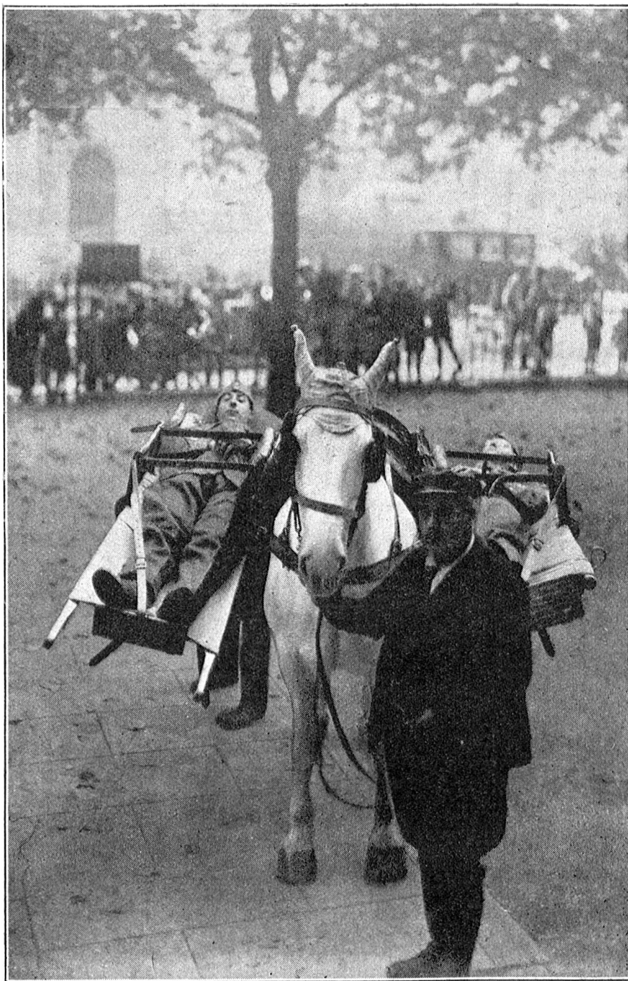
Fig. 23. Cacolet-litière du colonel van Baumberghen portant deux brancards chargés.
