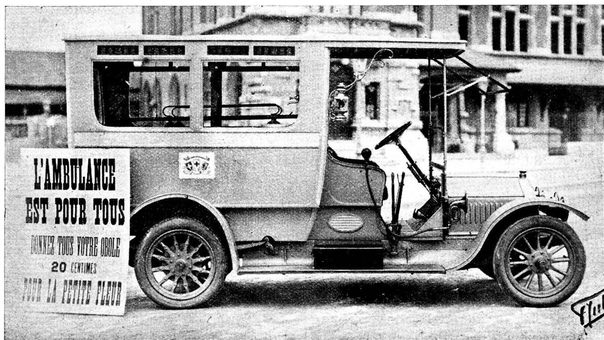
Kontinental-Pneumatik versehen. Die extra konstruierte Maschine ist eine 4 zylindrig 24 HP. Es ist für zwei auf Bahnen zu transportierende Patienten eingerichtet, so daß die Bahnen übereinander kommen. Daneben haben noch zwei Wärter Platz. Die ganze Konstruktion garantiert für einen äußerst schonenden Transport von Kranken und Verletzten und erregt gewiß den stillen Neid mancher Samaritersektion.
