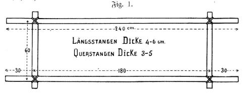
Icde improvisierte Tragbahre muß zuerst durch Belastung mit einem gesunden erwachsenen Mannsauf ihre Festigkeit geprüft werden, bevor sie zum Transport eines Kranken oder Verwuns deten verwendet werden darf.
