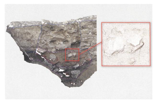
Abdigitalisierte Strukturen in AutoCAD Map. Das 3D-Modell besteht aus einer geschlossenen Oberfläche mit fotorealistischer Textur. Methode verwendet wurde: Die Strukturen aller CAD-Zeichnungen können in AutoCAD Map 3D mit Metadaten angereichert werden. Diese umfassen typischerweise die Aktennummer sowie ein Schlüsselfeld, das die Struktur eindeutig identifiziert und so die Möglichkeit einer Verknüpfung
